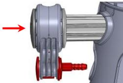
Placez le levier sur la position assemblage (à environ 45°), repérez le marquage sur l'arbre (ergots et nervure se situant à l'avant de la partie lisse de l'arbre) puis insérez-le jusqu'à ce qu'un clic se fasse entendre (premier cran, position réglage).
