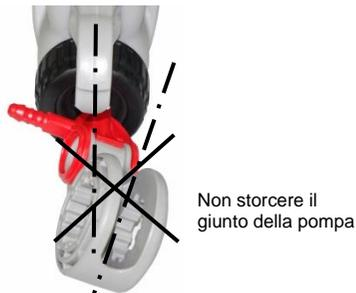
Introdurre con cautela l'intero gruppo nel cilindro dentro l'impugnatura della pompa. Allineare il giunto della pompa adattandolo alla leva della pompa (senza storcerlo). Spingere dentro la biella e serrare il dado a cappello.
