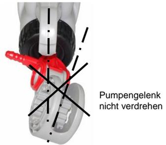
Komplette Einheit vorsichtig in den Zylinder im Pumphebel einführen. Pumpengelenk am Pumphebel ausrichten, Pleuel hineindrücken und Überwurfmutter festschrauben (Bild links). Zur Kontrolle Pumpengelenk vom Pumphebel streifen und Ausrichtung kontrollieren (Bild rechts).
