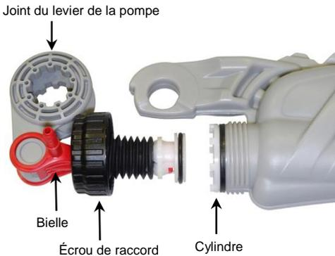
Dévissez l'écrou de raccord puis retirez le joint du levier de la pompe avec la bielle et le piston du cylindre.
