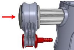
Pumphebel in die Montageposition bringen (ca. 45° Winkel), Markierung der Welle (vordere Nocken und Rippe ohne Einbuchtung) und Rahmen beachten und einführen bis er einrastet (erste Raste, Verstellposition).
