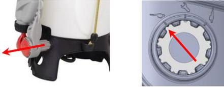
Pumphebel am Pumpengelenk herausziehen bis zur ersten Raste (Verstellposition). Pumphebel auf die gewünschte Position drehen und wieder hineinschieben bis er komplett eingerastet ist.
