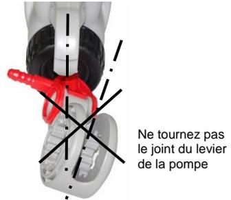
Introduisez avec précaution l'unité complète dans le cylindre dans la poignée de la pompe. Orientez le joint du levier de la pompe conformément avec le levier de la pompe (ne pas tourner). Enfoncez la bielle et vissez l'écrou de raccord.
