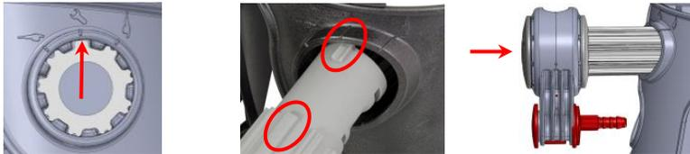
Portare la leva della pompa in posizione di montaggio (angolo di circa 45°), prestare attenzione alla marcatura dell'albero (cama anteriore e nervatura senza scanalatura), inserirla fino all'innesto (prima tacca, posizione di regolazione).
