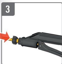
Sprührohr an Handventil schrauben
