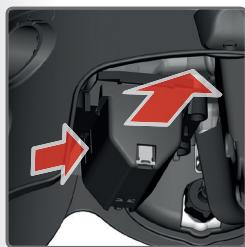
**Für Akkuwechsel Anschlusskabel ausschließen, Entriegelung drücken und herausziehen**
