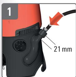
Schlauch an Windkessel schrauben
